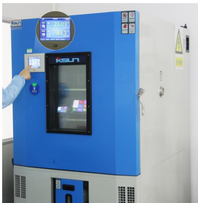
图 3-3 高低温老化测试图
